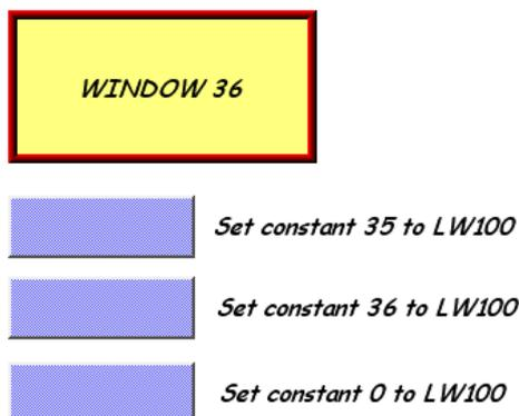
Независимо от того, какое окно открыто, нажмите кнопку SW\_2 — будет установлено значение 0 по адресу [LW100] и окно закроется. Другой способ закрытия рабочего окна: создать объект [function key] с функцией [close window]. При нажатии на этом объекте рабочее окно закроется.
