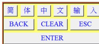
В окне клавиатуры используются объекты [Function Key], предназначенные для ввода изображенного на них символа. Например, чтобы создать клавишу символа ”简”, создайте объект [Function Key], в его свойствах в режиме [ASCII]/[UNICODE] задайте символ ”简” как показано ниже.
