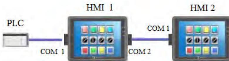
На рисунке выше панель HMI2 может управлять PLC через панель HMI1 путем установления соединения через COM-порты.
