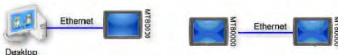
Термин “a remote HMI” (удаленная панель оператора) относится к панели оператора, управляемой через сеть другой панелью или компьютером, выполняющим имитацию проекта в режиме он-лайн. Для управления удаленной панелью оператора пользователю нужно добавить в список устройство данного типа. Щелкните [New...] и откроется диалоговое окно [Device Properties] (Параметры устройства). Требуется указать корректные значения всех атрибутов.
