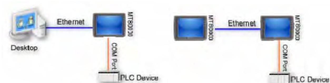
Термин “remote PLC” (удаленный ПЛК) означает контроллер, подключенный к удаленной панели оператора. Для управления удаленный ПЛК пользователю нужно добавить такой тип устройства. Щелкните [New...] и появится диалоговое окно [Device Properties] (Параметры устройства). Требуется указать корректные значения всех атрибутов.
