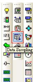
Перед использованием объектов типа [Trend display] или [History data display] для просмотра содержимого данных должен быть определен метод построения выборки. Щелкните по пиктограмме [Data Sampling] — откроется окно [Data Sampling Object].
