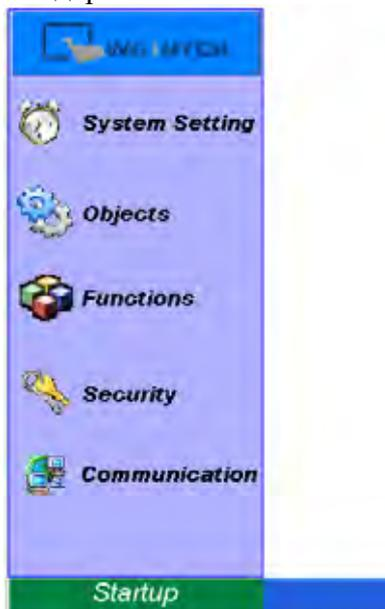
Для использования окна быстрого вызова (кроме случая создания первого окна 3) пользователю нужно задать каждую функцию быстрого вызова. [Startup] на рис. выше — кнопка быстрого вызова, которая используется для активации/деактивации функции быстрого вызова. Все настройки кнопки быстрого вызова прописаны в Системных настройках [SystemParameter Settings] (см. рис. ниже):
