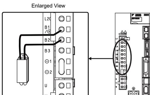
(3) SERVOPACKs: Model SGDV-470A, 550A, 590A, 780A, 210D, 260D, 280D, 370D
