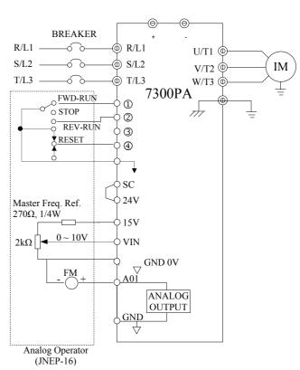
Fig. 7 Analog Operator
